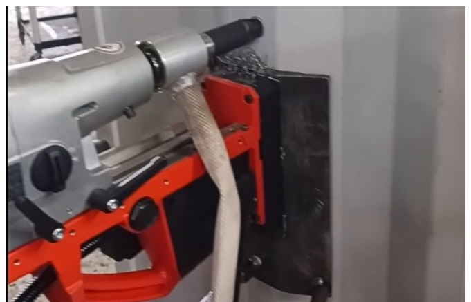
Die gebogene Vakuumplatte wird wie folgt verwendet - auf einem 20 Fuss ISO-Container
