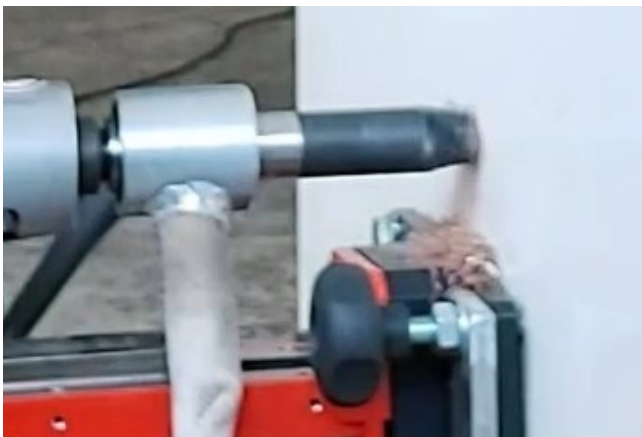
So wird die flache Vakuumplatte verwendet - an einer BD30 Brandschutztür
